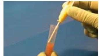
Den Konuseinsatz, der die Dosierspitze enthält, gegen den Uhrzeigersinn drehen und aus dem Röhrchen entnehmen, in dem Sie ihn nach oben ziehen.
