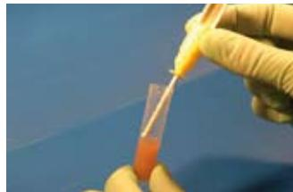
Homogeneice la muestra sometiéndola a vórtex durante 30 segundos, déjela reposar durante al menos 10 minutos y sométala nuevamente a vórtex durante 30 segundos utilizando un mezclador vibratorio. Repita este paso hasta que en la punta dosificadora ya no queden heces.
