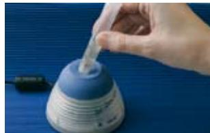
Probe ca. 30 Sek. unter Verwendung eines Vibrationsmixers vortexten, danach 10 Min. stehen lassen und im Anschluss erneut für 30 Sek. vortexten. Diesen Schritt wiederholen bis sich die Probe vollständig aus den Rillen der Dosierspitze gelöst hat.
