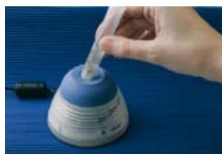
omogeneizzare il campione vortexando per 30 secondi, lasciarlo a riposo per almeno 10 min e vortexare nuovamente per 30 sec. Ripetere questa operazione finché le feci non sono state completamente rimosse dai solchi sull'asticella.
