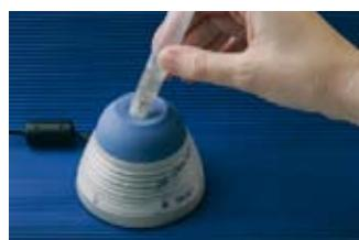
homogénéiser l'échantillon en vortexant pendant 30 sec., laisser reposer le tube verticalement pendant 10 min puis vortexer à nouveau pendant 30 sec. Répéter cette opération jusqu'à ce qu'il ne reste plus de selles dans les cavités de l'embout du doseur.
