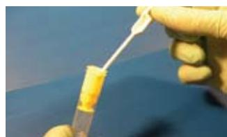
tourner l'embout du doseur dans le sens inverse des aiguilles d'une montre puis le sortir en tirant vers le haut.
