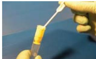
Dosierspitze gegen den Uhrzeigersinn drehen und nach oben herausziehen.
